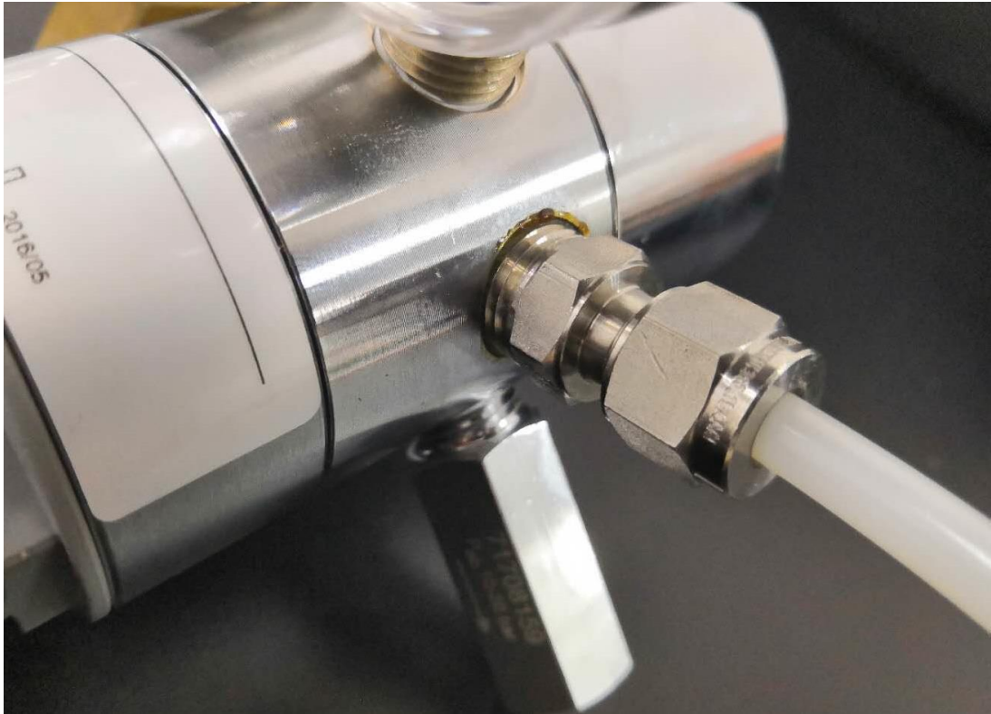
减压阀与塑料进气管的接口处
