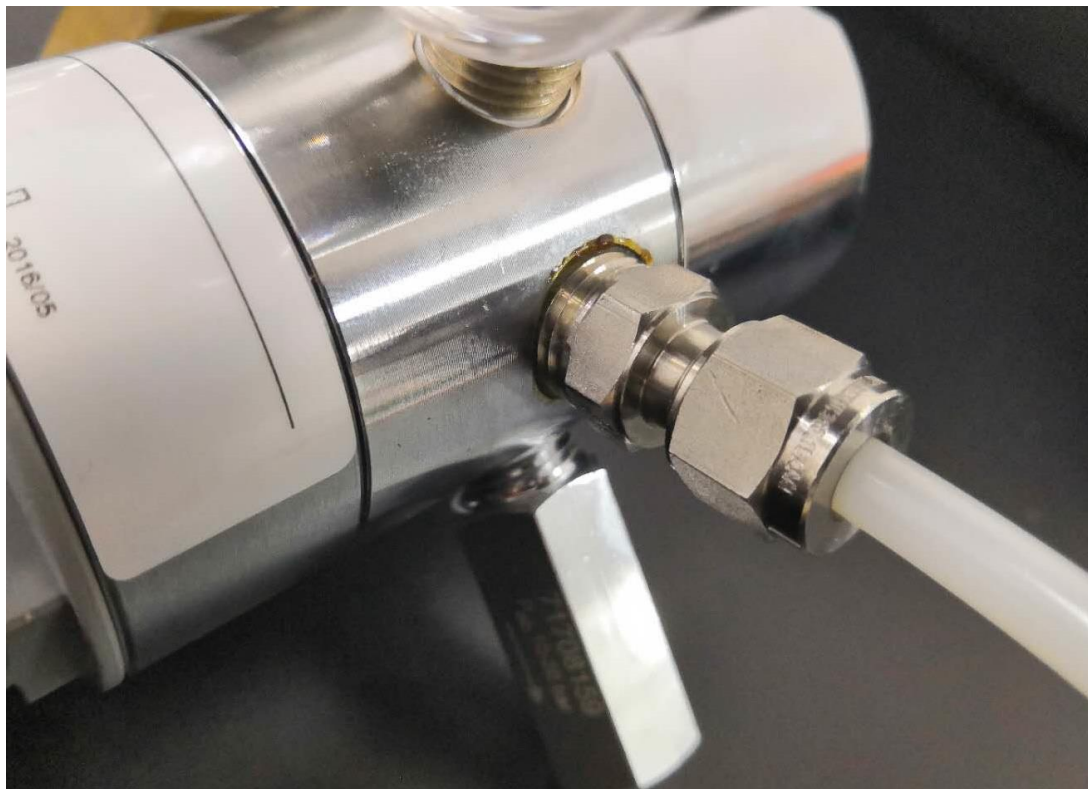
减压阀与塑料进气管的接口处
