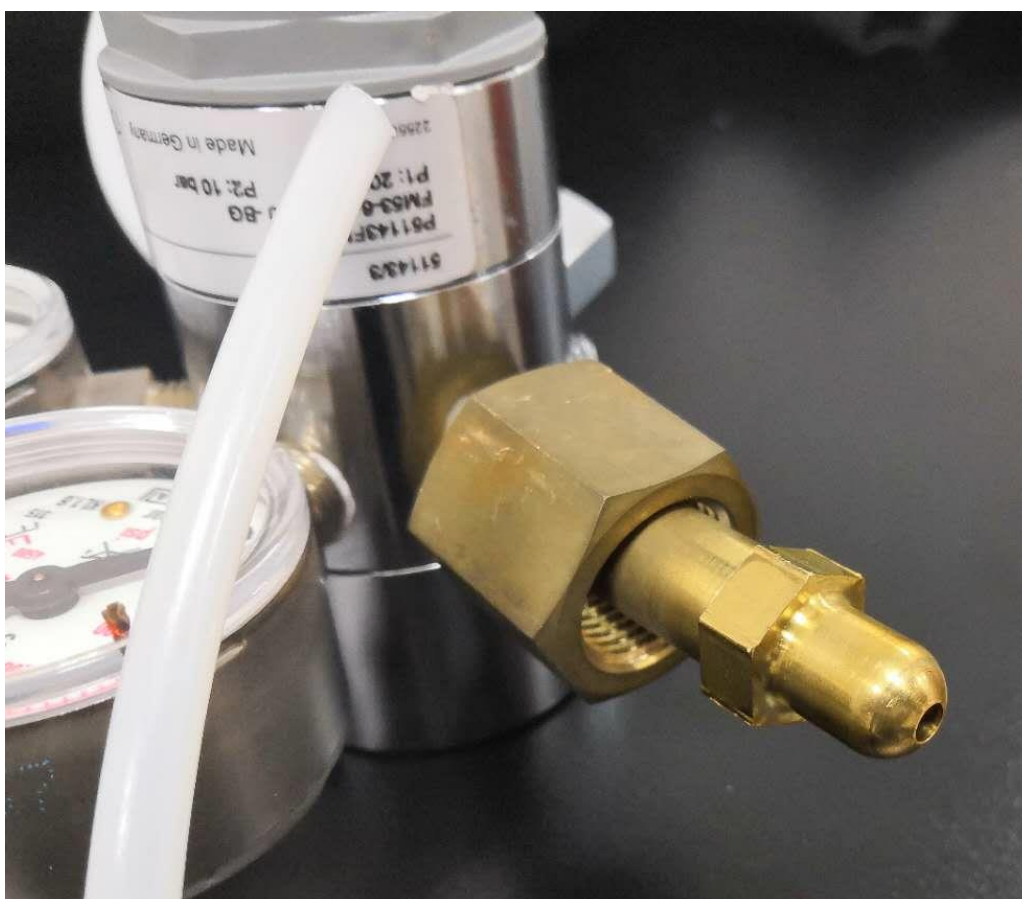
请注意减压阀与钢瓶连接的接口螺丝尺寸为 G5/8"
